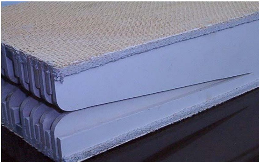
Parti in corda-amianto (corde tra le alette del pacco ceramico)
