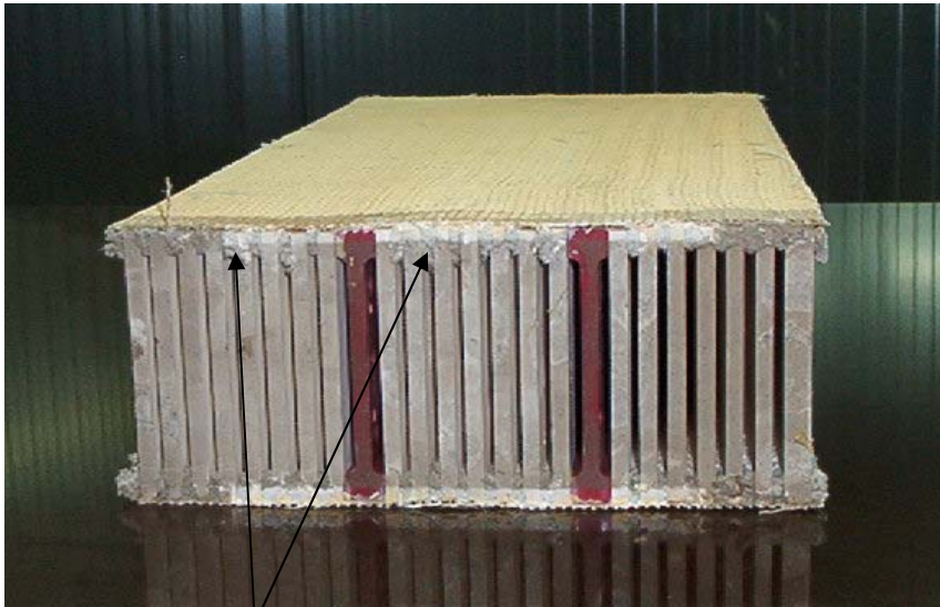
Parti in corda-amianto (corde tra le alette del pacco ceramico)
