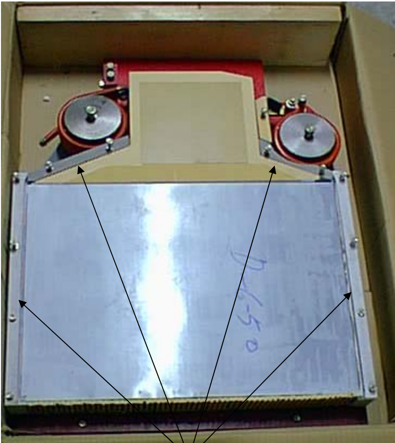
Parti potenzialmente in cemento-amianto
